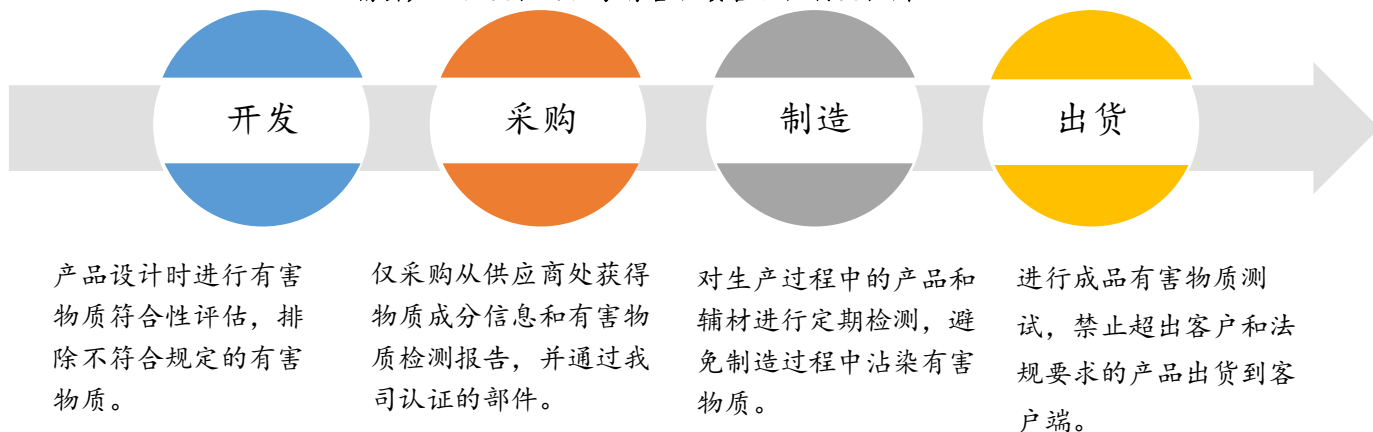
立讯精密产品全流程的化学有害物质管理控制流程图
